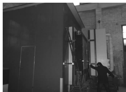
图3 防护热箱法墙体传热系数测定过程
